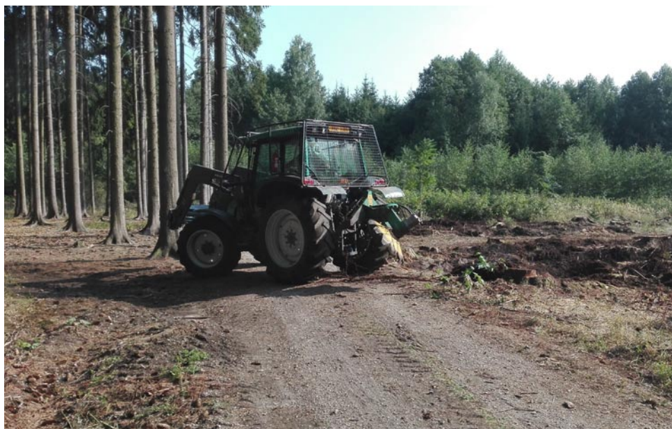
Příprava půdy pro přirozenou obnovu talířovou půdní frézou (Alexandra Hardegg)
